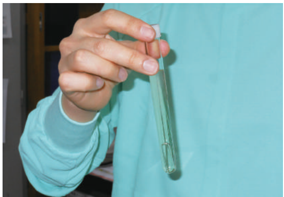
使い捨ての滅菌済み培地に試料を添加する（写真は新宿高野・府中工場）。試験管内のダーラム管は、わずかでもガスが発生すると浮上する。
